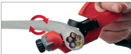
Gerät auf die Markierung der Abisolierlänge aufsetzen und den Rundschnitt durchführen
