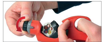
Klingenschnitttiefe mittels Drehknopf einstellen (Uhrzeigersinn)
