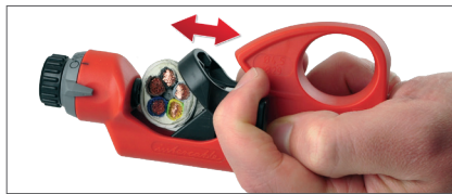
Das Gerät mittels Federkraft an das Kabel spannen
