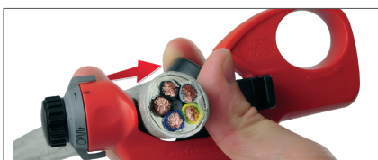
Für Längsschnitt Stellung auf das Symbol Längsschnitt (→) umstellen und Gerät axial in Längsrichtung ziehen
