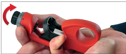
Abisoliergerät entsperren durch Drehen vom Stellung auf das Symbol Rundschnitt (⊙)
