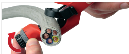
Stellung auf das Symbol Spiralschnitt (⌘) umstellen und Arbeitsgang durchführen
